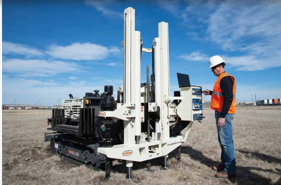
The Geoprobe® 20CPT Press mounted on a 6712DT.
